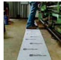
b) kot vpojni trak: odporna zgornja plast in mehka spodnja plast, ki se trdno oprime tal
